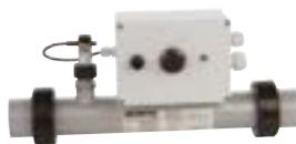
En **titane**, corde de chauffage en Incoloy 825, coffret avec thermostat réglable 0 - 40°C et thermostat de sécurité 47°C, avec platine insérée (relais plus nécessaire), diode lumineuse, retardement d'enclenchement, câblé complètement avec interrupteur de circulation, surface laquée, avec deux manchons PVC NW 50.
