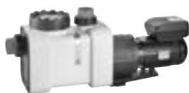
Pompe **sans garniture mécanique** pour la piscine. La puissance du moteur est transférée sans contact et sans usure via un couplage magnétique de la coque de confinement à la roue.
