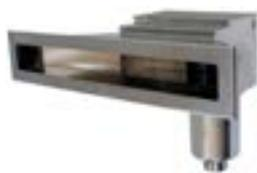
Grand clapet de skimmer dans la partie inférieure du skimmer et raccord d'aspiration 2" tar. / 2½" fil. Le skimmer dispose d'une chambre à niveau dans laquelle un régulateur de niveau électronique doit être installé. Un niveau d'eau minimal d'env. 60 mm est ainsi possible. Avec panier de skimmer profond.
